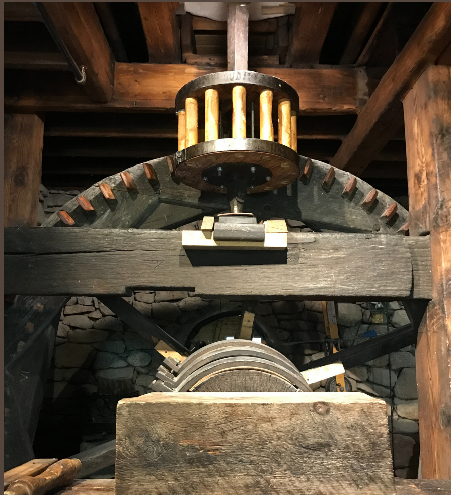
Getriebe der Plymouth Gristmill, MA - USA
