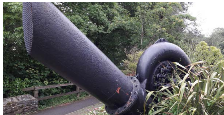
Eine Spiralturbine, Gilbert Gilkes & Gordon LTD Kandal No 4270 1937 in Ivybridge (Devon). Foto: Dr. Ralf Krejner 2018.
